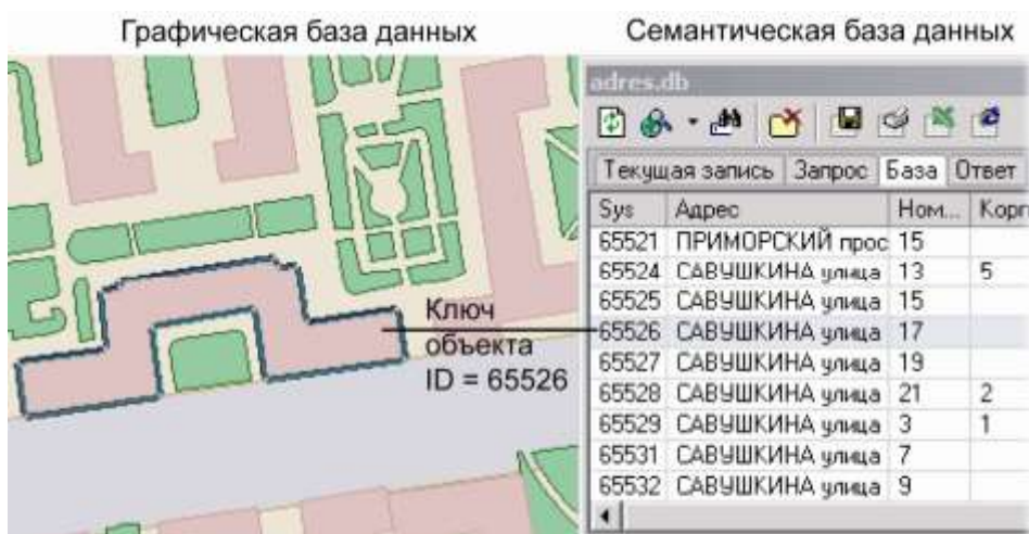
Рисунок 4.2. Пример взаимодействия семантической и графической баз данных
