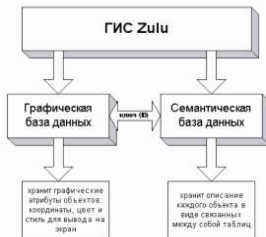
Рисунок 4.1. Структурная схема представления информации в системе Zulu
